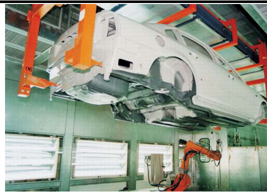
抗石击车底PVC涂胶（参考示意图）
